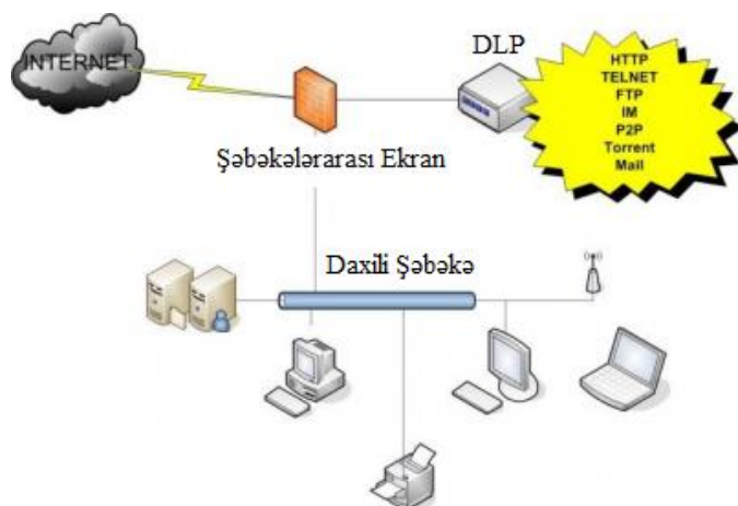
Şəkil 1. DLP sisteminin şəbəkəyə qoşulma sxemi
