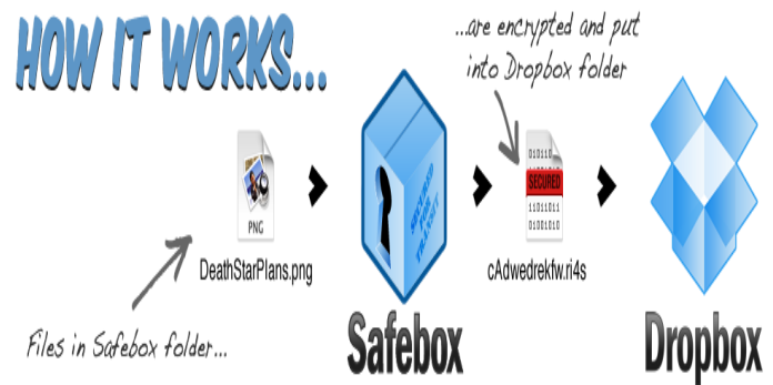
Şəkil 3. Faylların Dropboxda şifrələnməsi mexanizmi Yaradılan mobil proqram əlavələri mobil qurğuların əməliyyat sistemlərindən və qurğunun tipindən asılı olmur.
