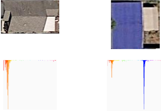
Şəkil 1. Fərqli binaların damının rənglərinin rəng koduna görə paylanması. Yuxarıda: orjinal təsvir; aşağıda: rəng qiymətinə (Hue) görə alınmış histoqram.
