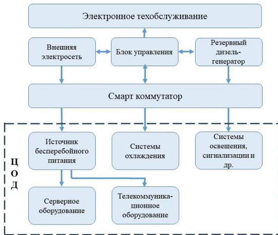
Рис.1. Схема энергообеспечения с однократным резервированием
